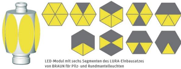
LED-Modul mit sechs Segmenten des LURA-Einbausatzes von BRAUN für Pilz- und Rundmantelleuchten
