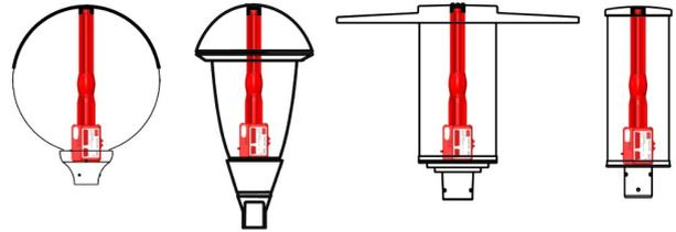
LURA-LED-Einbausatz von BRAUN mit MaxiDimm3000.
