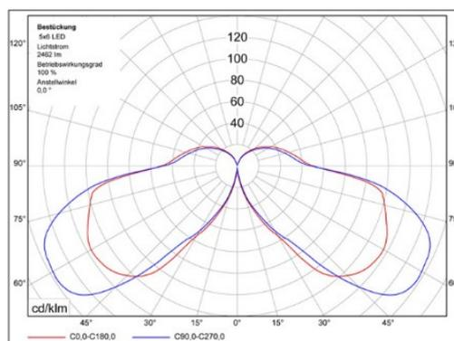
Spezialreflektoren für homogene Ausleuchtung
